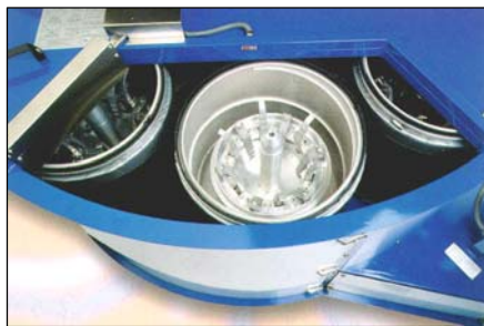
Die Schleuderköpfe stehen bei der Zentrifuge HYDROC zur Beschickung still
